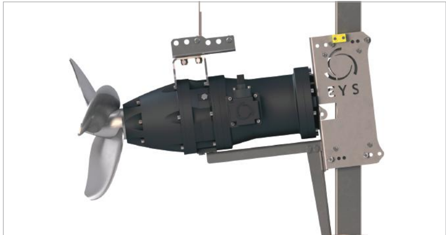
Einbau bei -7° zur Aktivierung der am Boden abgesetzten Feststoffe Installation with -7° to activate settled solids at the bottom
