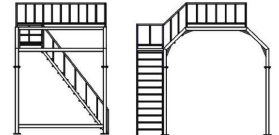
EYS produziert Arbeitsbühnen für Pressschnecken Separatoren, um Ihren Trennvorgang zu erleichtern. Wir haben speziell entworfene Selbstleiter-Separator Plattformen, um die abgetrennte feste Fraktion aus dem Separator zu stapeln oder direkt in den Anhänger oder auf ein Transportfahrzeug zu füllen.
