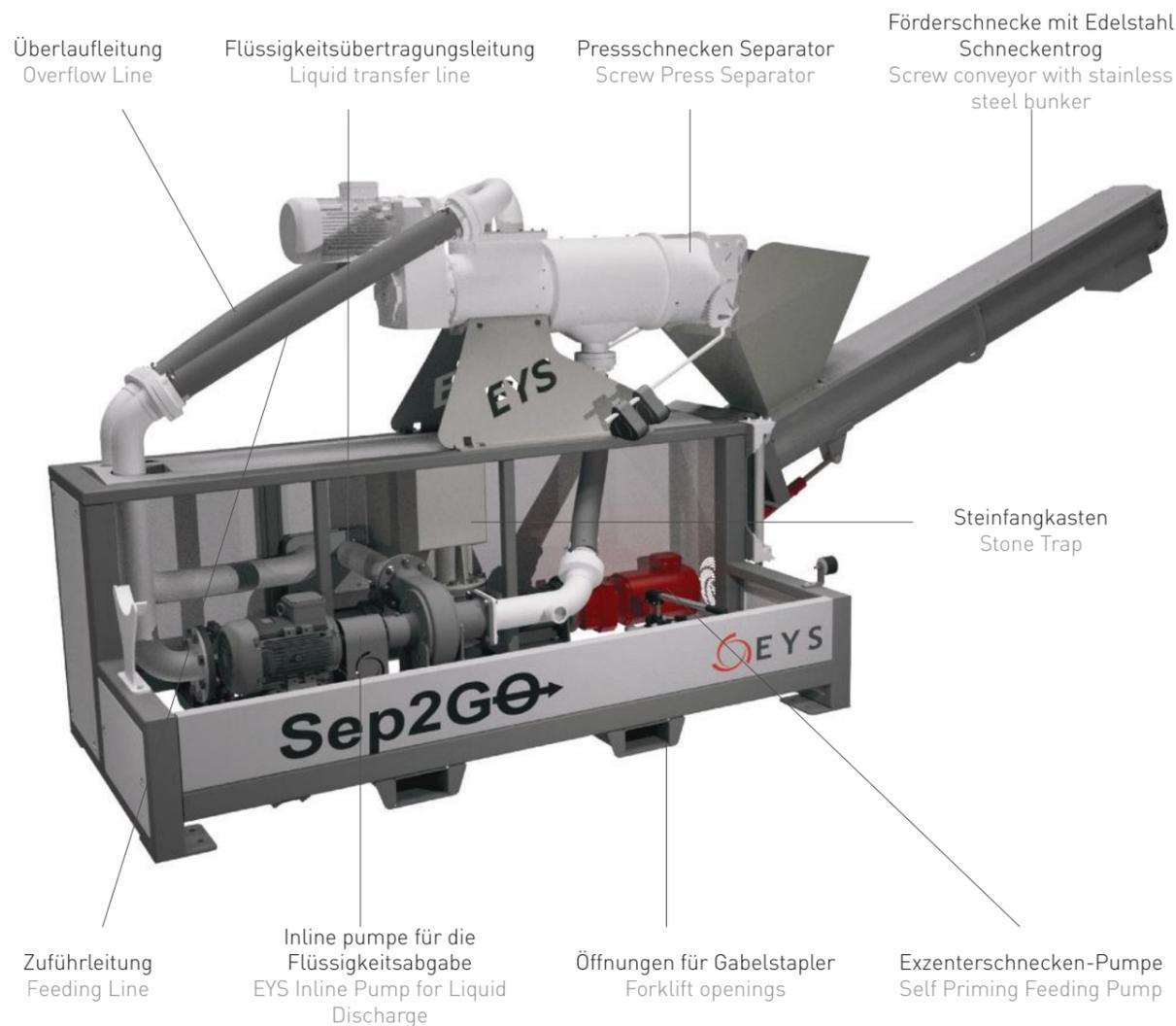
Sep2GO™ ist ein kompaktes und komplettes System, das alle notwendigen Komponenten zur Separierung enthält. Der Sep2GO™ besteht aus den folgenden Komponenten: Pressschnecken-Separator, Exzentrerschnecken-Pumpe zur Ansaugung der zu separierenden Flüssigkeit, Kreiselpumpe für die separierte Flüssigkeit, Förderschnecke für die separierten Feststoffe, Anschlüsse für die Schläuche, Steuerungsschaltschrank sowie ein stabiler Rahmen der mit einem Gabelstapler versetzt werden kann.
