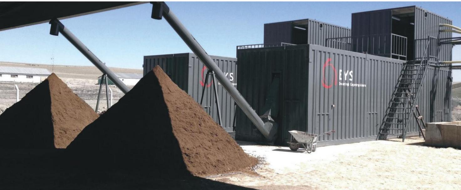
Es wird für den Vergärungsprozess keine zusätzliche Wärme in das System eingeleitet. Die Feststoffe erhitzen sich selbst bis zu 70°C als Ergebnis der exothermen aeroben Vergärung, entsprechend den EU-Hygiene- Anforderungen.
