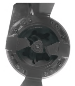
Unteransicht vom Laufrad und einstellbaren Schneidmessern Bottom view of Impeller and cutting blades
