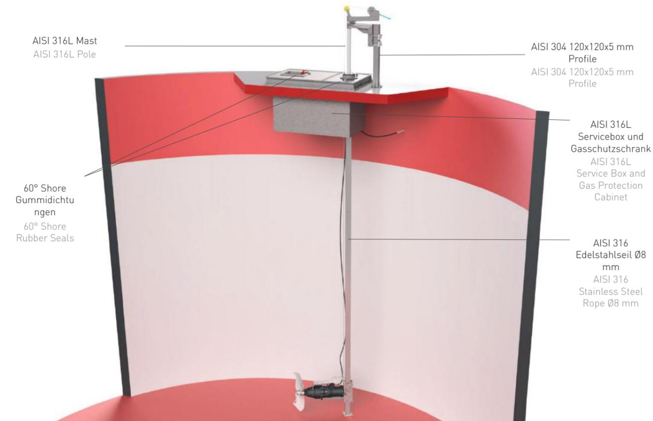
Die speziell für Biogastanks entwickelten EYS-Serviceboxen sind mit Tauchmotorrührwerken mit hoher und mittlerer Drehzahl kompatibel. Der Gasschutzschrank minimiert den Gasaustritt bei der Mischerentnahme. Dank des hervorragenden Designs sind alle Teile an einem einzigen Ort zugänglich. Der Prozess im Inneren des Tanks kann durch das Beobachtungsfenster auf der Servicebox beobachtet werden.
