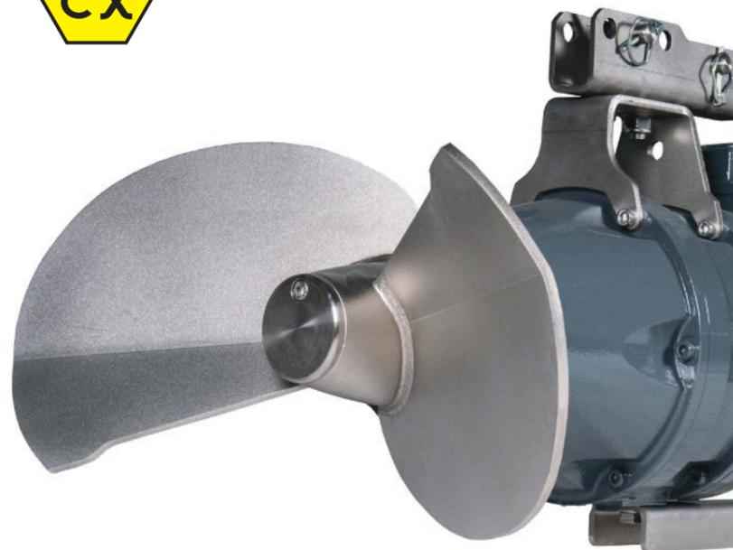
Tauchmotorrührwerke der DK-Serie können mit 2-Blatt- oder 3-Blatt-Propellern verwendet werden. 2-Blatt-Propeller sind für den Einsatz in Slalom-Kanäle und Kassetten-Podests geeignet. 3-Blatt-Propeller können einen großen Bereich beeinflussen. Es kann dort eingesetzt werden, wo ein höherer Schub erforderlich ist, ohne den Stromverbrauch zu erhöhen.
