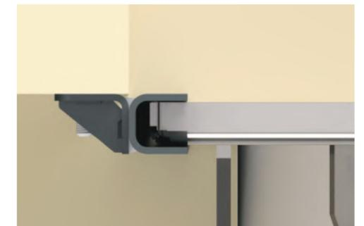
Verbindungsdetails von Umlaufrahmen mit U- und Z-Schienen
