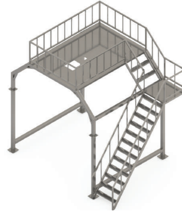
Modüler Galvanizli Platform (SP600 ve daha büyük modeller için) Modular Galvanized Platform (For SP600 and bigger models)
