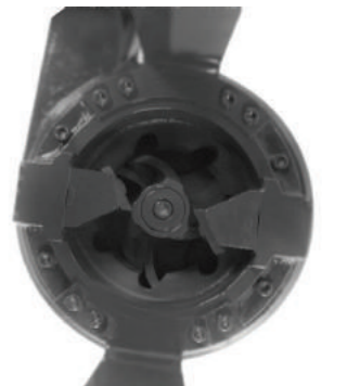
Fan ve kesici bıçakların alttan görünüşü Bottom view of Impeller and cutting blades
