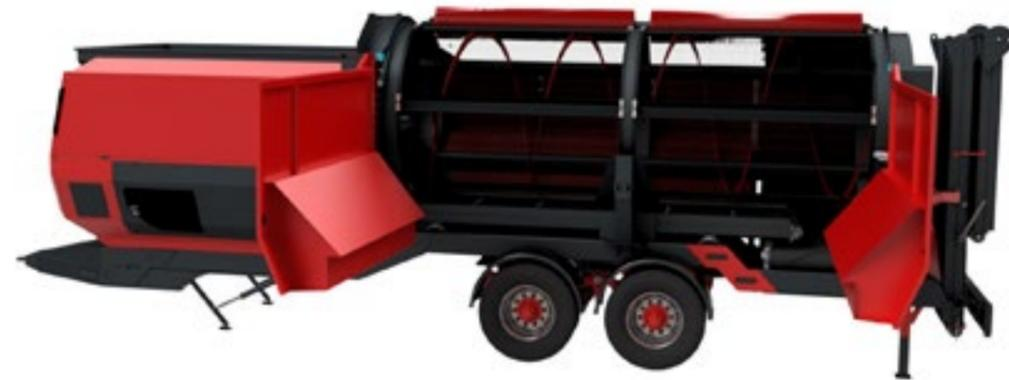
Die Trommelsiebmaschine ist geeignet für die Kompostsiebung und kann stationär oder mobil eingesetzt werden. Die Trommelsiebmaschine wird über einen robusten Einfülltrichter befüllt. Danach wird das Kompostmaterial mit einem Förderband in das Trommelsieb transportiert. Das Trommelsieb wird von einem robusten Hydromotor angetrieben. Die Trommelsiebmaschine besteht aus drei Förderbändern, die den abgeschiedenen Feinsand in zwei separate Haufen trennen.
