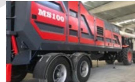
Die Kapazität der mobile Zerkleinereinheit beträgt mindestens 65 m³/h. Das Material wird durch einen 3 m³ großen Trichter über die Zerkleinerungskammer geführt. Die rotierenden Messer mit ihren rundum angeordneten Haken fördern das Material zur Mitte der Zerkleinerungskammer. Durch die Klängen wird das Material zerrissen und fällt durch Schwerkraft unter den Zerkleinerer.
