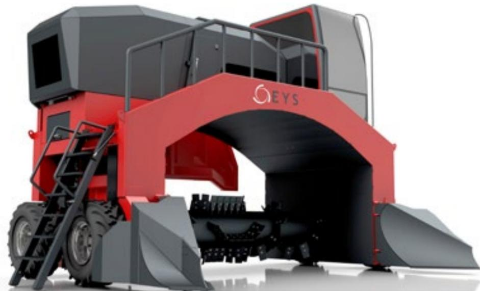
KYK wurde speziell entwickelt für Massenmischverfahren bei großen Kompostanlagen. Mit zwei Joystick-Einheiten in der komfortablen Fahrerkabine mit Panorama-Blickwinkeln bietet er einen hohen Bedienungskomfort. Die rechten und linken Räder mit voneinander unabhängiger Zugkraft verleihen dem KYK eine hohe Mobilität im Einsatzbereich und in engen Rückfahrbereichen.
